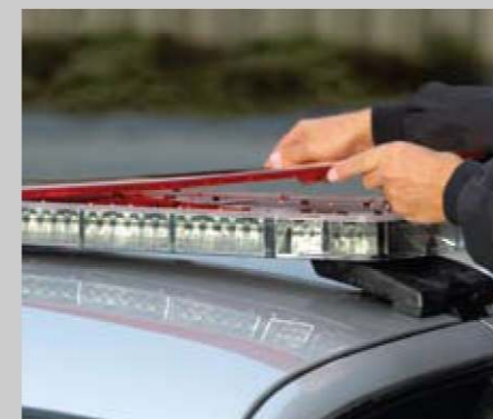
1 Entfernung der Abdeckung mit nur 2 Schrauben.
